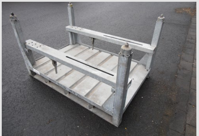
Stahlrahmen für Doppelstockverladung
