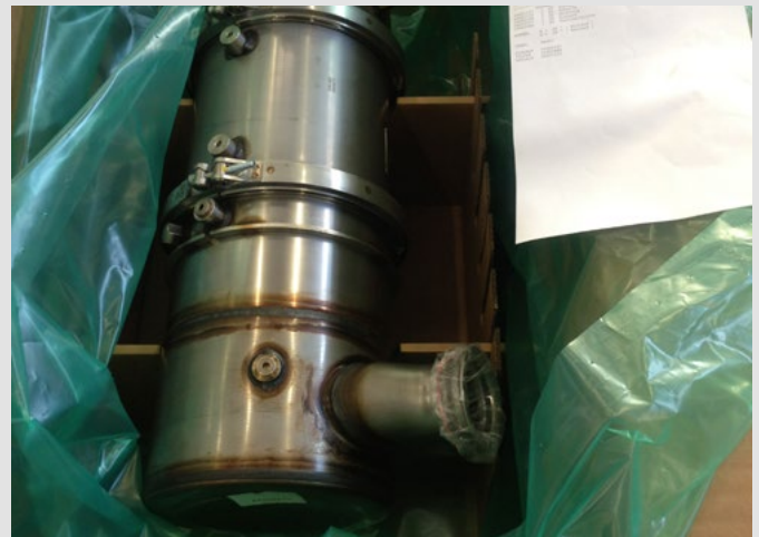
DPF in Kartonverpackung mit VCI Schutzhaube
