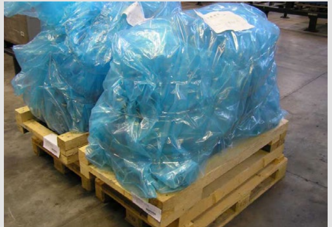
Motor mit VCI-Schutzhaube
