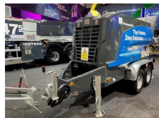
Prototyp der 1. elektrifizierten Betonpumpe
