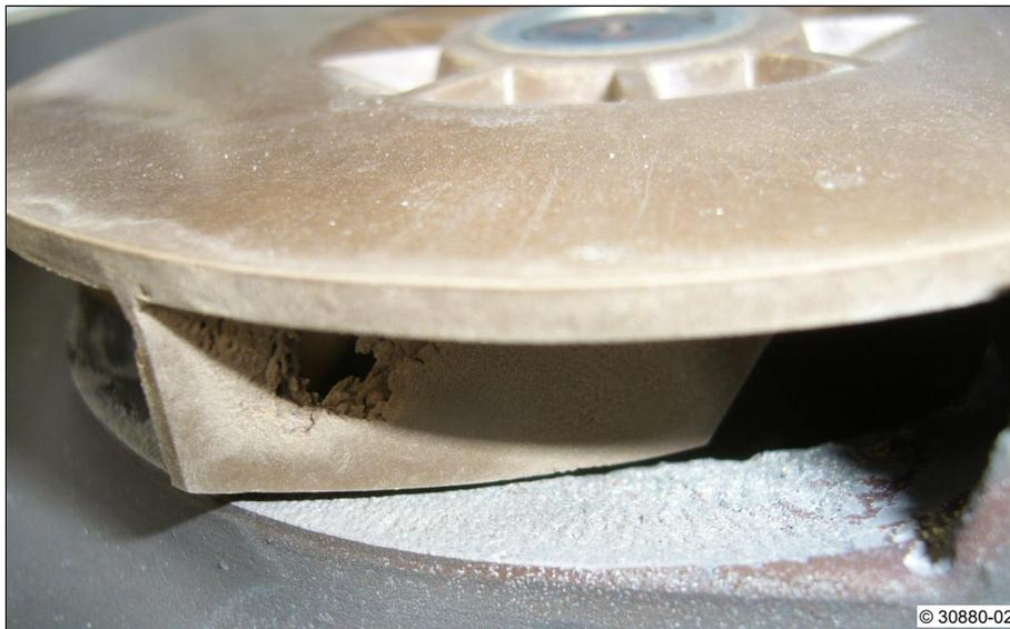
A15: Flügelrad der Kühlflüssigkeitspumpe, kavitiert
