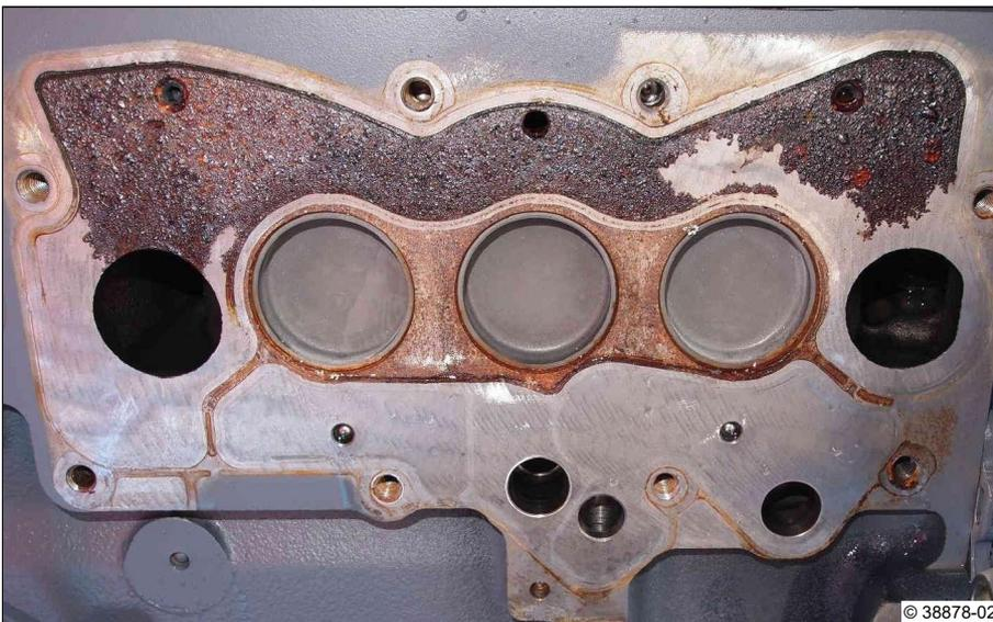
A7: Kurbelgehäuse im Bereich des Schmierölkühlergehäuses
