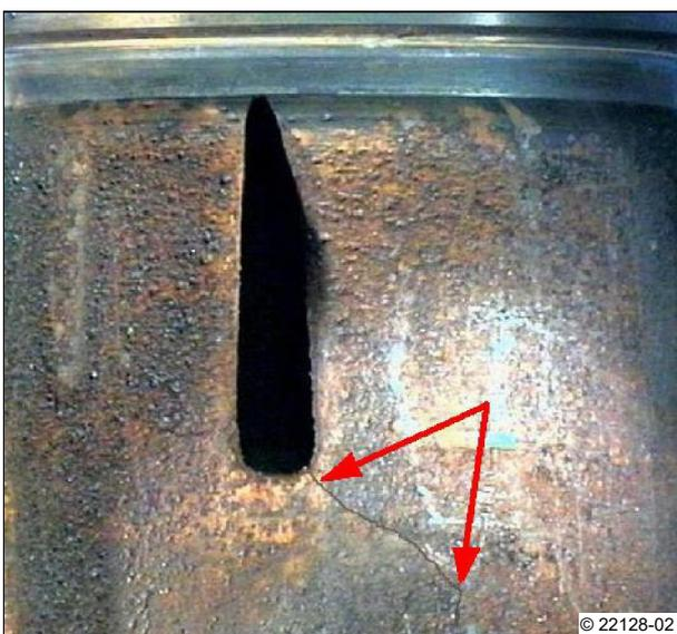
A3: Kurbelgehäuseriss im Bereich der Zylinderlaufbuchse
