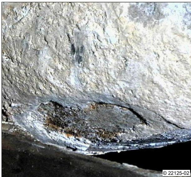
A13: Kalkablagerung an einer Zylinderlaufbuchse
