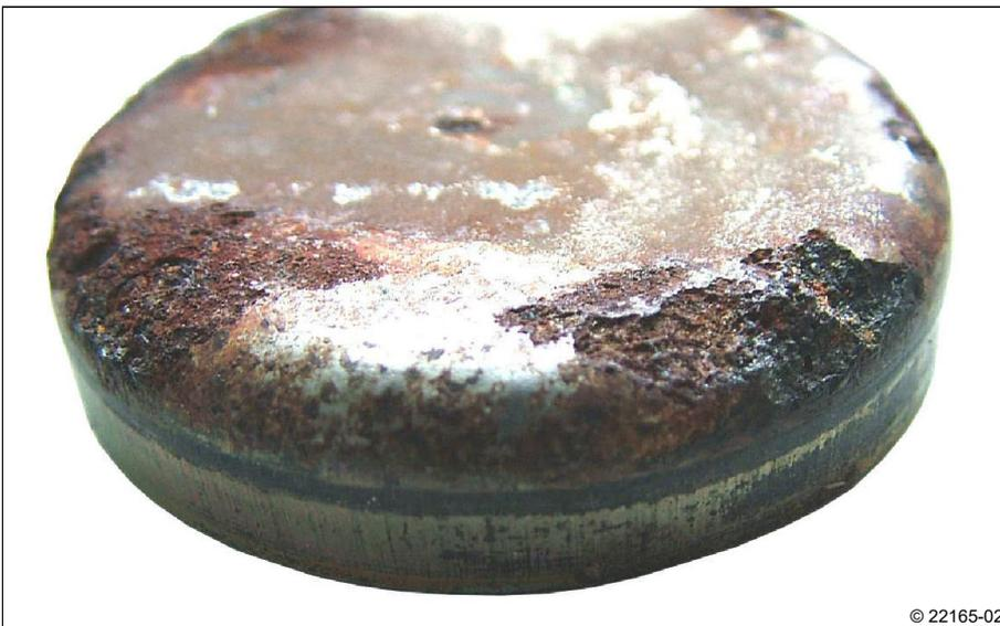
A11: Verschlussdeckel, korrodiert
