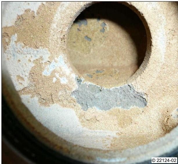
A12: Thermostatdeckel aus Aluminium, korrodiert
